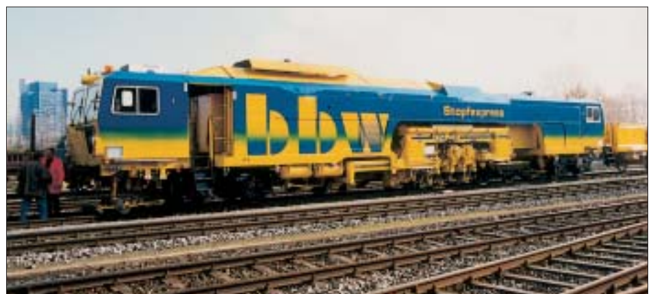
Bild 7: Kontinuierliche Drei-Schwellenstopfmaschine Stopfexpress 09-3X
